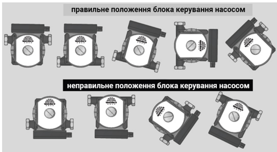
Рисунок 3. Схема положень встановлення насоса у систему.
